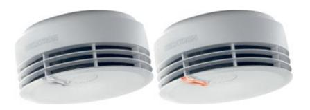
Die kleine Anzeigeleuchte blinkt regelmäßig (alle 48 Sekunden), um anzuzeigen, dass der Rauchwarnmelder funktionstüchtig ist. Dank der integrierten Echtzeituhr bei Genius H® und Genius Hx® wird die Leuchstärke der LED von 22:00 Uhr bis 06:00 Uhr automatisch reduziert.
